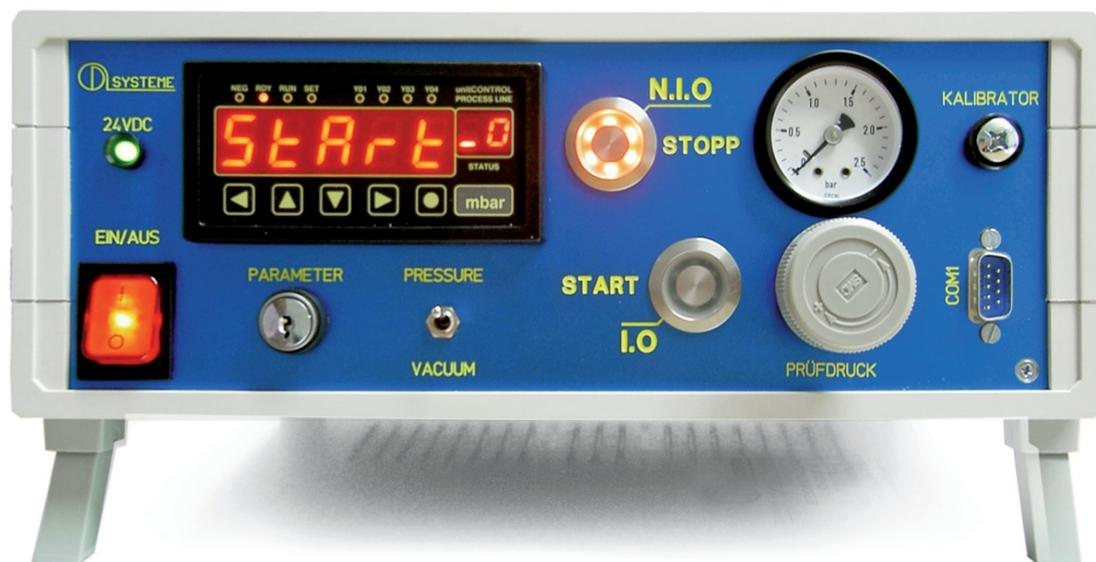
*Mikrokontroller gesteuertes Prüfgerät für die wahlweise Dichtheitsprüfung unter **Überdruck und Vakuum** zur serienbegleitenden Qualitätskontrolle.*
