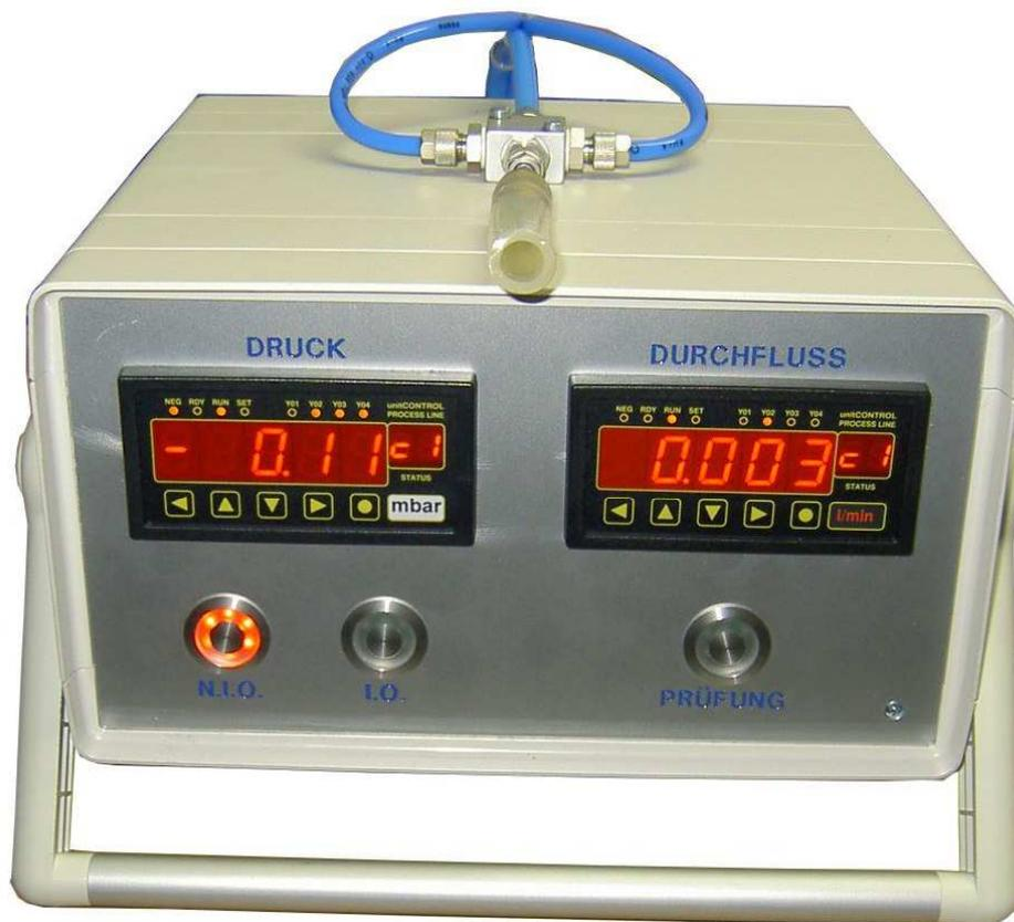
Mit dem Schalter FÜLLEN wird zunächst der Prüfling mit Druck beaufschlagt. Die Befüllung erfolgt hierbei sowohl über den Durchflußtransmitter wie auch über eine Bypassleitung (Überlastschutz für den Durchflußtransmitter). Nach Erreichen des über den frontseitigen Präzisionsdruckregler frei einstellbaren Prüfdruck ist der Schalter „MESSEN“ zu betätigen und anschließend der Schalter „FÜLLEN“ auszuschalten.
