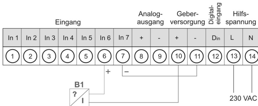
Messung eines **Spannungssignals** (5 V oder 10 V) von einem **3-Leiter-Transmitter**, unter Verwendung der Geberversorgung; Hilfsspannung 24 VDC.
