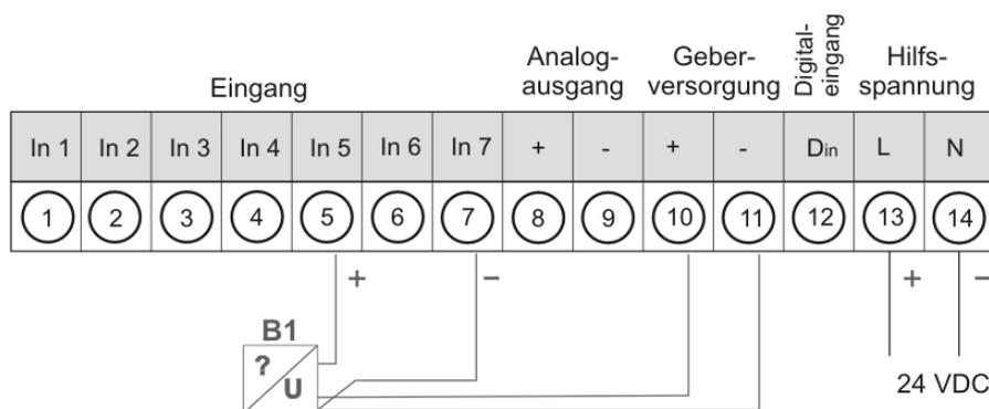
Messung eines **Spannungssignals** ( $\leq 2,5$  V) von einem **3-Leiter-Transmitter**, unter Verwendung der Geberversorgung; Hilfsspannung 230 VAC.
