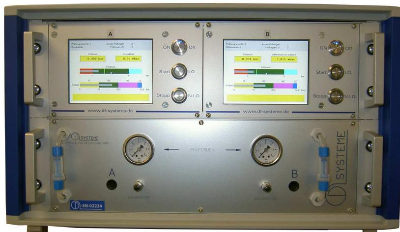
Lecktestgerät zur zeitgleichen, unabhängigen Prüfung von 4 Teilen.
